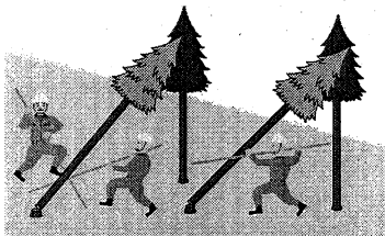
(図2)かかり木の処理
