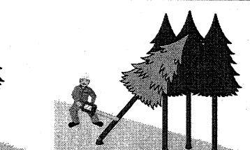
(図5)かかっている木の元玉切り
